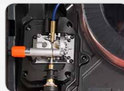
Kempact 181/251-modellene har trådmateren GT02 med 2-hjulsdrev.
